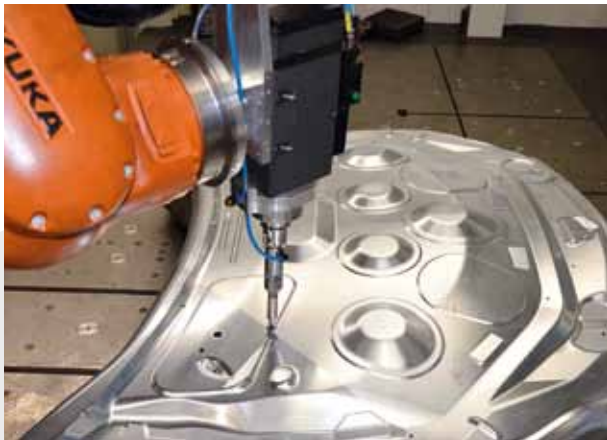
Einsatz FORGEfix beim Kaltschmieden von Serien-Ziehwerkzeugen auf einer Roboteranlage in der Automobilindustrie
